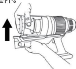
3) 按下集塵杯底部側邊鎖扣倒掉集塵杯內垃圾。
