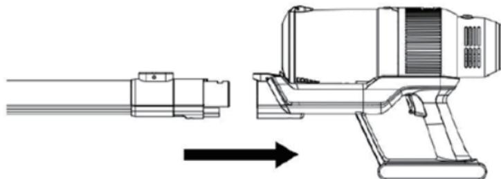
4) 將電動地刷插入到延伸管的另一端，直到聽到鎖扣 " 啪 " 的一聲。
