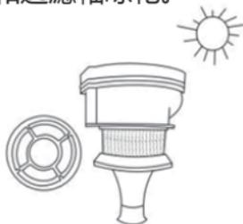
6) 按照圖示方向裝好HEPA濾網和過濾軸，注意卡槽位置。
