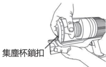
2) 按照圖片所標示的方向移動集塵杯，即可取下集塵杯。
